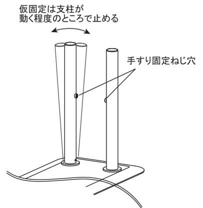
2. 手すりを支柱に差込み、手すり高さのガイド線を確認しながら手すり高さを決める。手すり固定ねじを手回して2回転ほど仮固定した後、六角棒スパナ(呼び4mm)で奥まで締付ける。
